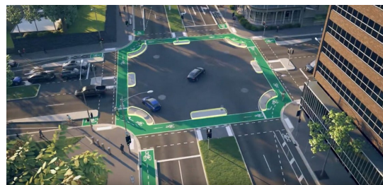
图 17 荷兰式交叉口：自行车停车线提前、增设缘石保护转弯自行车、连续的地面喷涂
